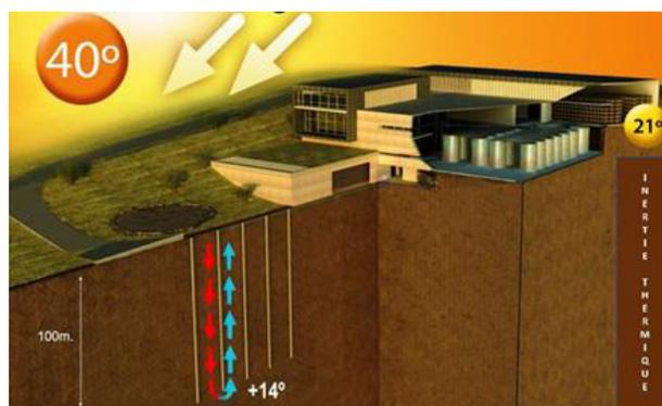
**Figure 20.** Application de géothermie dans les caves qui permet de bénéficier de l'inertie thermique du sous-sol (fraîcheur en été et chaleur en hiver), Bodegas Regalia de Ollauri dans la Rioja en Espagne, [www.marquesdeteran.com](http://www.marquesdeteran.com).
