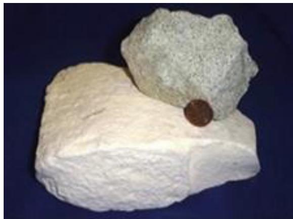
**Photo 12.** Une zéolite est une roche formée d'un squelette microporeux d'aluminosilicate, dont les espaces vides permettent d'optimiser l'adsorption et les processus de biodégradation du système racinaire des roseaux. Source [www.amethyst.it](http://www.amethyst.it).
