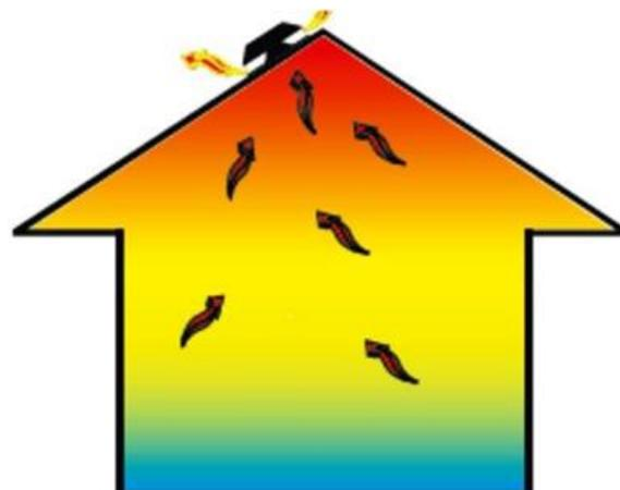
**Figure 18.** Variations de température selon la hauteur dans un bâtiment, Schéma J. Rochard.
