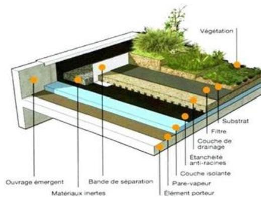
**Figure 14.** Structure d'un toit végétal, [www.liaisonvegetale.com](http://www.liaisonvegetale.com).
